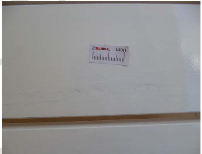
钻孔不良 + 凹痕 + 胶水痕
