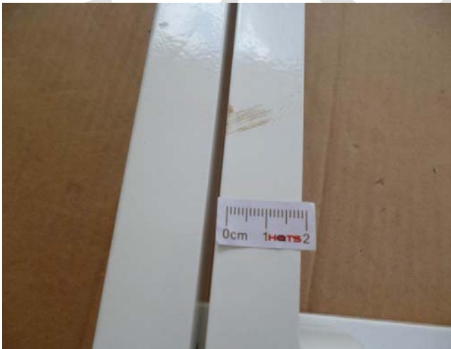
钻孔不良 + 凹痕 + 胶水痕
